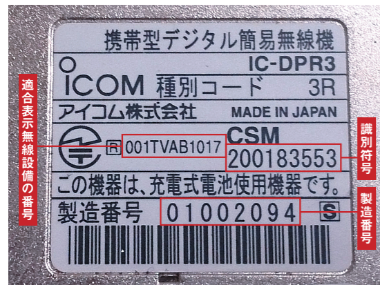
写真1 登録申請に必要な識別符号などは、電池ボックス裏や背面パネルに添付されたシリアルナンバーシールに記載されている
